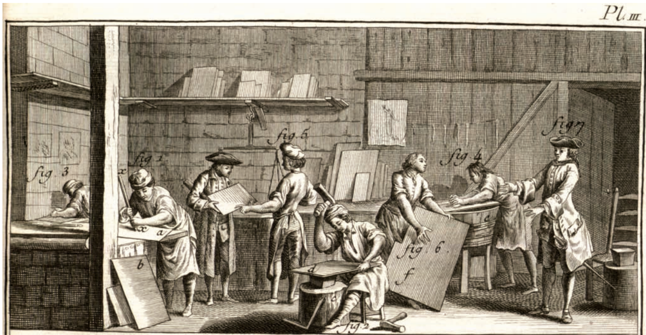
FIG. 717. PROCESS OF PREPARING A COPPERPLATE TO BE DELIVERED TO THE ENGRAVER (FIGS. 6 AND 7 AT RIGHT). Detail from Denis Diderot and Jean Le Rond d'Alembert, eds., Encyclopédie, ou, Dictionnaire raisonné des sciences, des arts et des métiers , 17 text vols. and 11 plate vols. (Paris: Briasson, David, Le Breton, Durand, 1751–72), Recueil de planches, sur les sciences, les arts libéraux, et les arts mécha-
